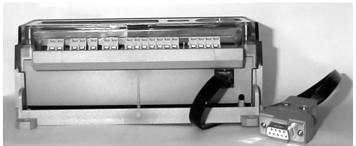
Abbildung 2: Verbindung des Parametrieradapters mit Metcom T I..
